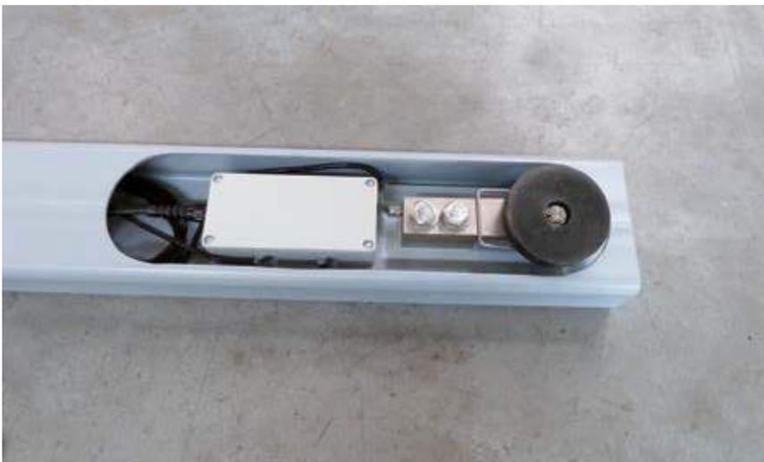
Wägezellen und Anschlusskasten
