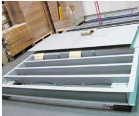
Schwerlastwaage mit geöffneter Platte
