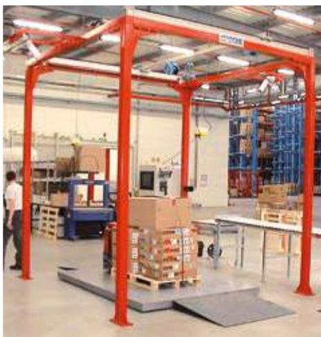
Volumenportal, Bodenwaage mit Auffahrrampe
