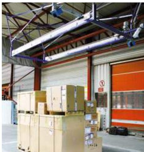
Deckenmodul Volumen, Bodenwaage eingebaut
