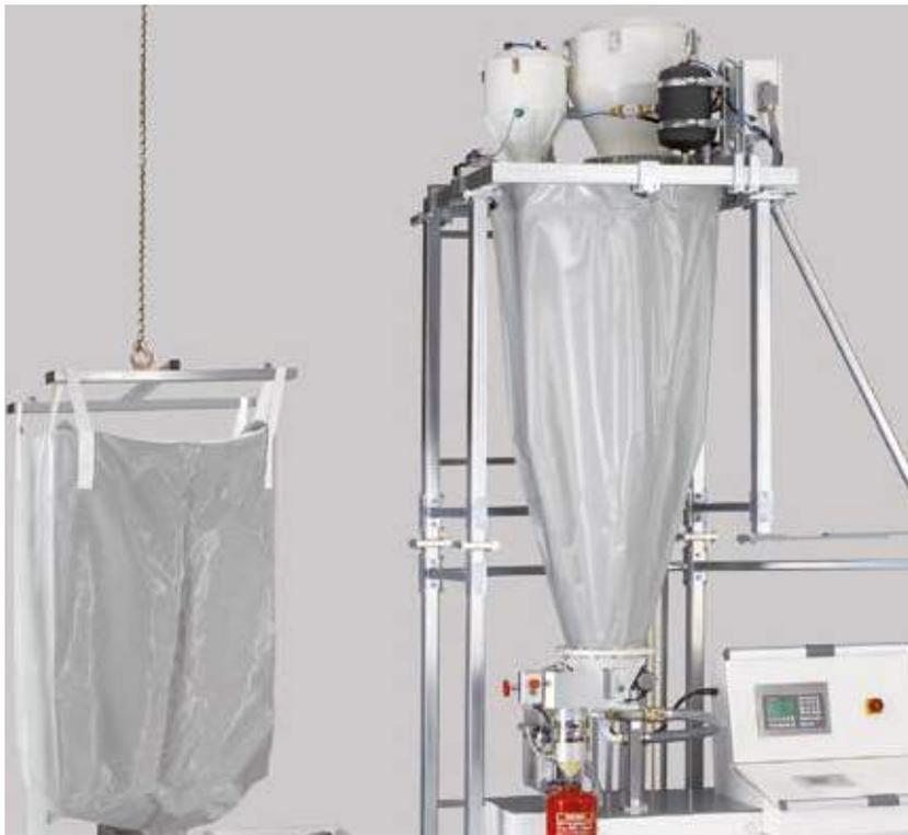
Komplette Abfülldosieranlage für Feuerlöscher
