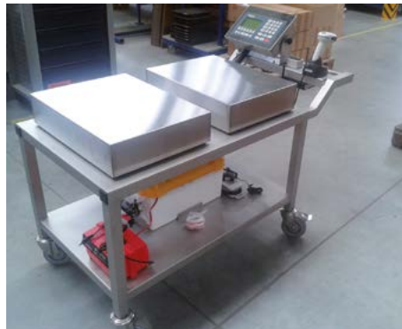
Doppelwaage auf Fahrgestell mit Rollen, Barcodescanner und Batterieversorgung
