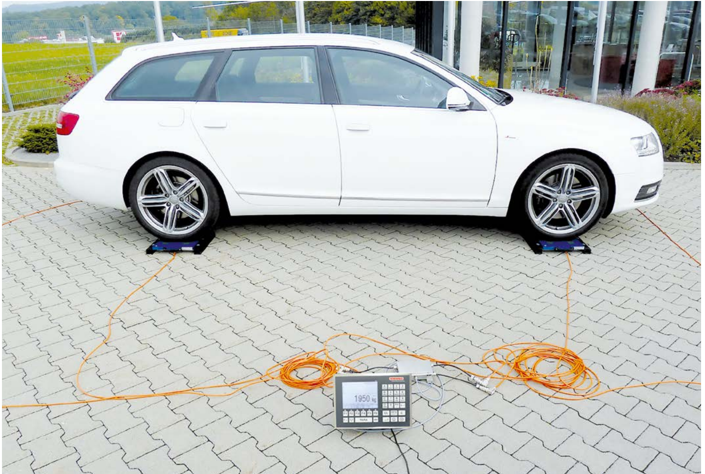
Beispiel: 4 Lastplatten steckbar als Gesamtgewichtswaage
