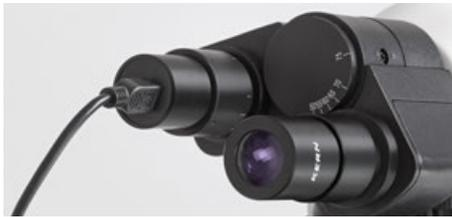
Okularkamera am Tubus befestigt
