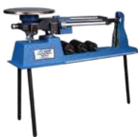
Stativbeine ermöglichen Unterflurwägung
