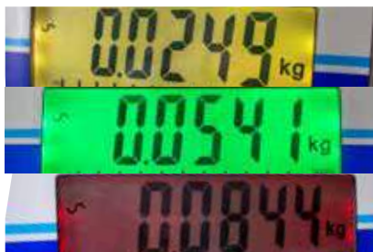
LCD-Anzeige mit Hintergrundbeleuchtung, deren Farbe zur Unterstützung der Kontrollwägung je nach Ergebnis wechselt
