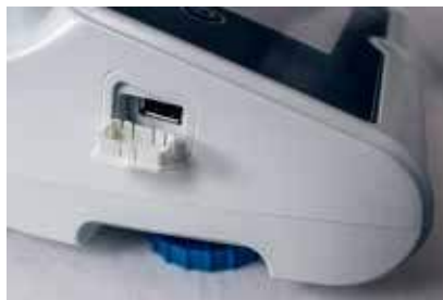
USB-Host zum Verwenden eines USB-Sticks
