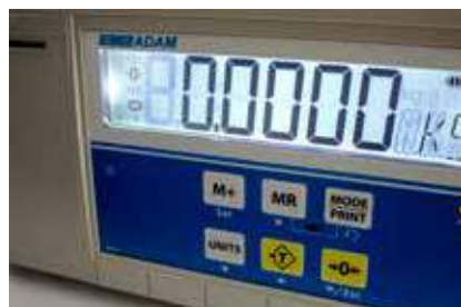
Große, 34 mm hohe Ziffern auf beleuchtetem Display
