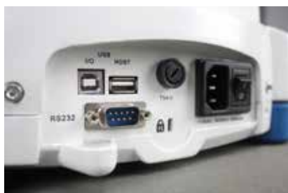
USB-Host zum Sichern der Daten auf einem Speicherstift
