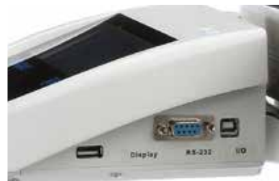
USB I/O und RS-232 Schnittstellen für schnellen Datenaustausch mit Computern und Druckern
