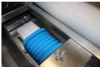
Wasserfeste, gekapselte, silikonbeschichtete Wägezelle
