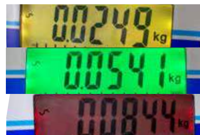
Hintergrundbeleuchtetes Display mit Farbwechsel für einfaches Kontrollwiegen (AE 403)
