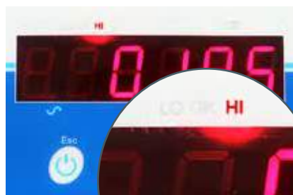
LED Kontrollleuchten zeigen an, wann die gewünschten Grenzwerte erreicht sind
