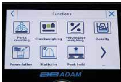
Großes, ansprechendes 125mm Anzeige mit 800x480 Pixel und Touchscreen
