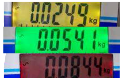
Das hinterleuchtete LCD wechselt die Farbe abhängig vom Erzielen voreingestellter Grenzwerte
