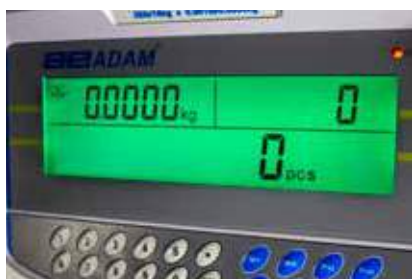
Hinterleuchtete LCDs für Gesamtgewicht, Stückgewicht, und Menge
