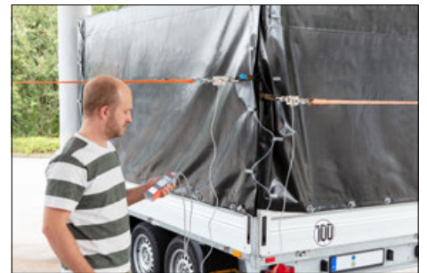
Messen von Kräften in verschiedenen und Dimensionen mit nur einem Messgerät möglich
